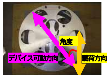
写真2 上盤可動部分（橋脚側）
