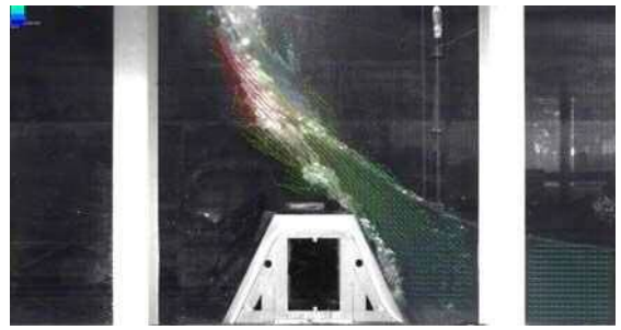
写真3 画像解析による流速分布測定結果
