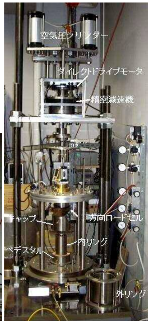
写真1 多層リング単純せん断試験装置
