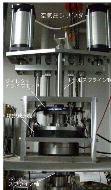
写真2 荷重装置部分
