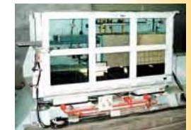
模型振動実験土槽
