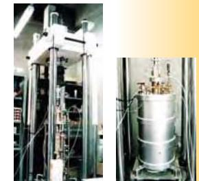
大型三軸圧縮試験装置と
