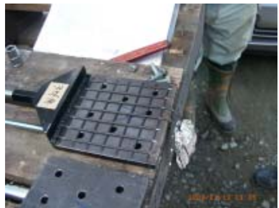
図4 引き抜き試験片の設置状況 a) 敷設状況 b) つかみ部 (破断後) c) つかみ部 (分解時)
