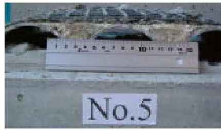
写真 6 定着破壊状況（土のう平滑面）
