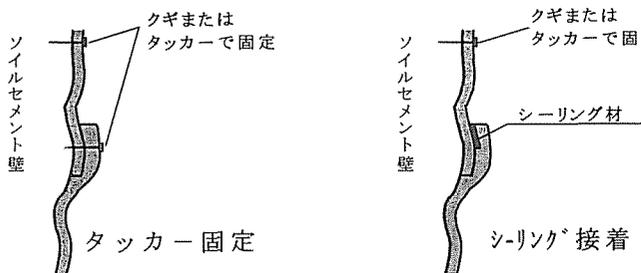
図1 接着性先防水シートの重ね合せ部の処理方法施工状況
