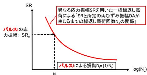
図-3 累積損傷度理論における損傷の定義
