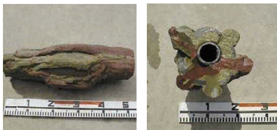
写真2 繰返し注入による補強体の造成例
