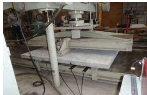
図 - 2 曲げ試験に用いた載荷装置
